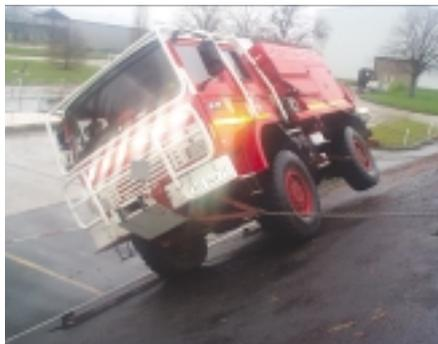
Essai de stabilité statique transversale pour un véhicule incendie.
